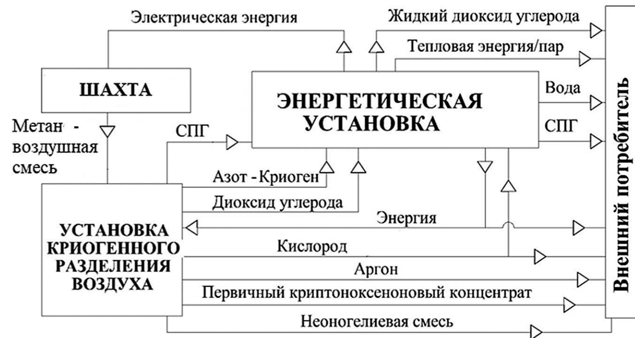
Принципиальная схема энерготехнологического комплекса с бескомпрессорной ПГУ для шахт
