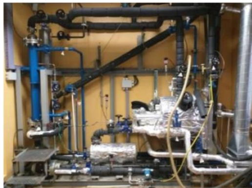
Стенд для исследований макетов теплообменников установки ОЦР. Лаборатория МНИЛ ЗАО НПВП «Турбокон», г. Калуга
